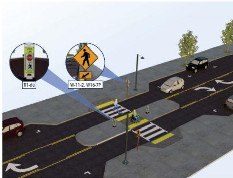
Προέκταση πεζοδρομίου για αμεσότερη διάσχιση
