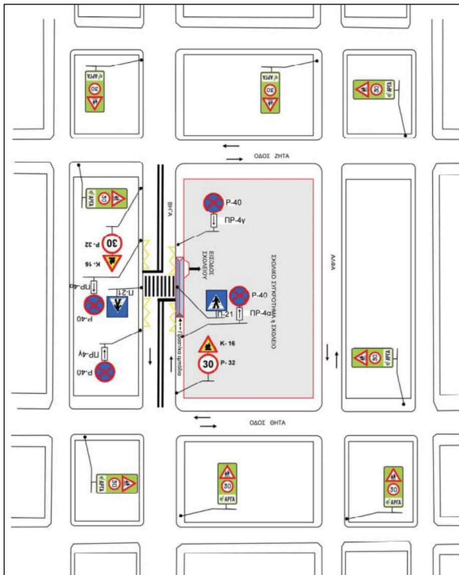
Κατακόρυφη και οριζόντια σήμανση πέριξ του σχολικού τετραγώνου (ΦΕΚ Β 2302/16.9.2013)
