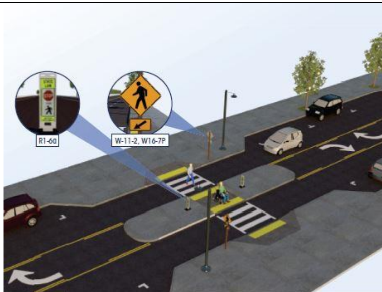
Προέκταση πεζοδρομίου για αμεσότερη διάσχιση
